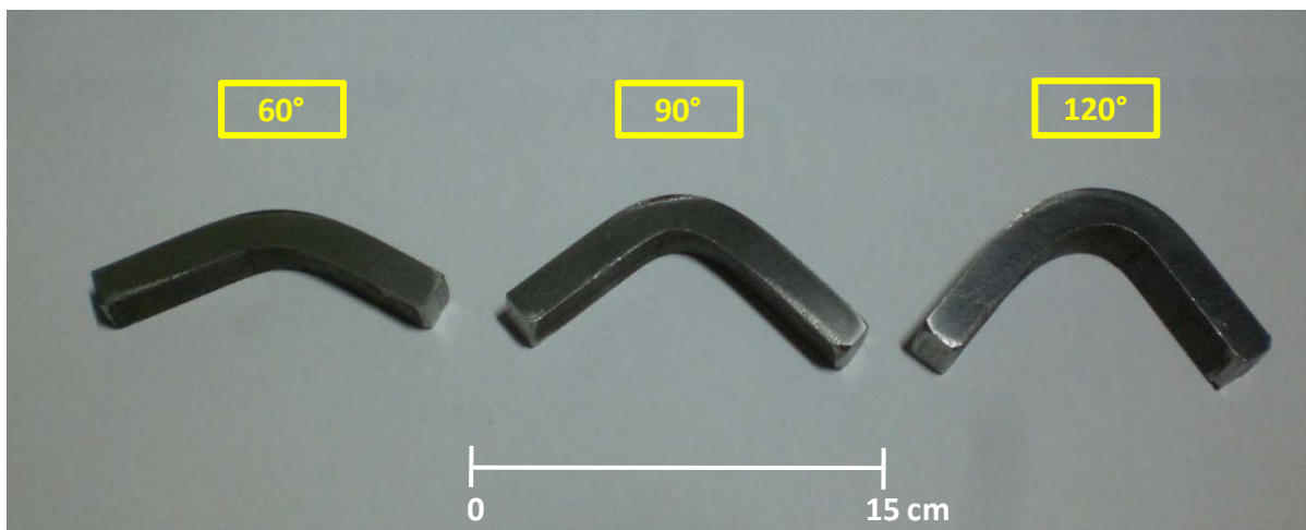
Figura 1. Fotografia de um conjunto de três amostras do material com os graus de dobramento aplicados.
