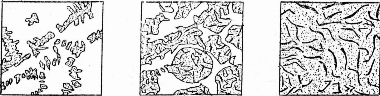
Fig.1 - Sequência esquemática da solidificação de um ferro fundido cinzento hipoeutético.
