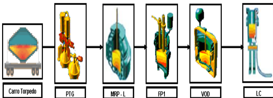
Figura 1. Fluxograma de produção do aço GNO.
