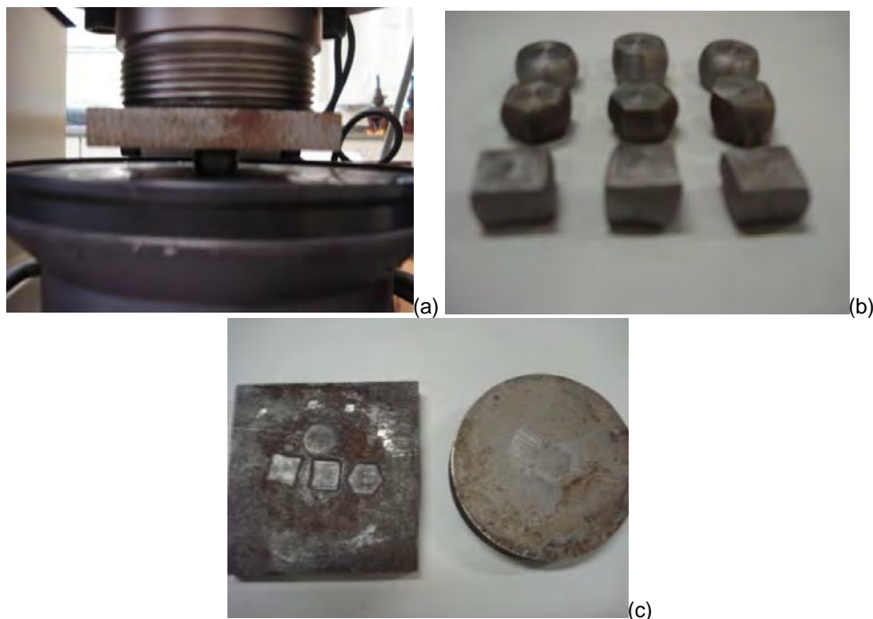
Figura 13. Ensaio de compressão Físico – (a) Final ensaio de tração; (b) corpos de prova após os ensaios; e (c) placas usadas para proteger a máquina.
