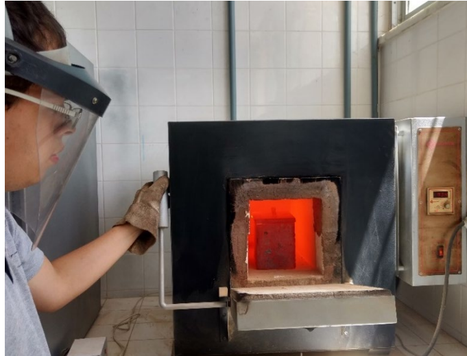
Figura 3. Caixa de aço colocada em forno mufla a 920°C. Fonte: Autor.
