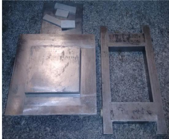
Figura 2. Matriz metálica para confecção de placas compósitas.
