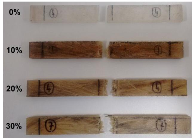
Figura 6. Corpos de prova de compósitos de matriz epóxi reforçados com fibras de malva nos percentuais de 0%, 10%, 20% e 30%v/v, após ensaio de flexão em 3 pontos.
