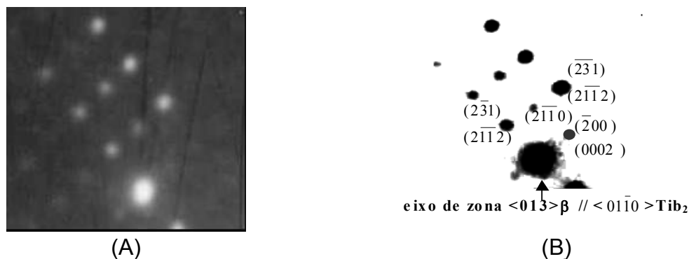
Figura 7. Difração em MET de amostra na condição de envelhecida a 430°C por 5 min. em região indicada na Figura 5(A).
