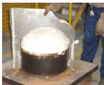
Figura 12 - Fôrma de Isopor Junta de Expansão Tubo Reto AF # 3.
