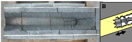
Figura 10 - Corte com muitas trincas.
