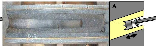
Figura 11 - Corte com poucas trincas.
