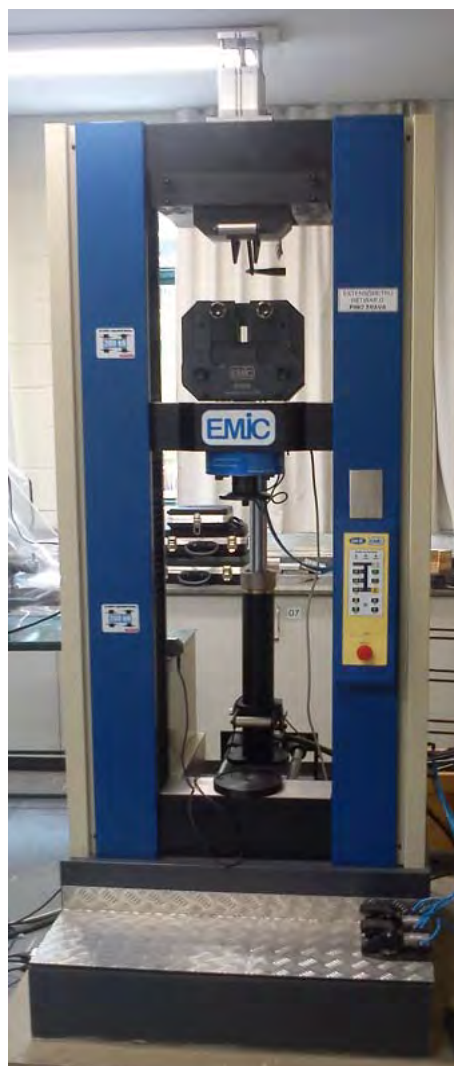
Figura 4. Máquina EMIC utilizada para o ensaio de compressão.
