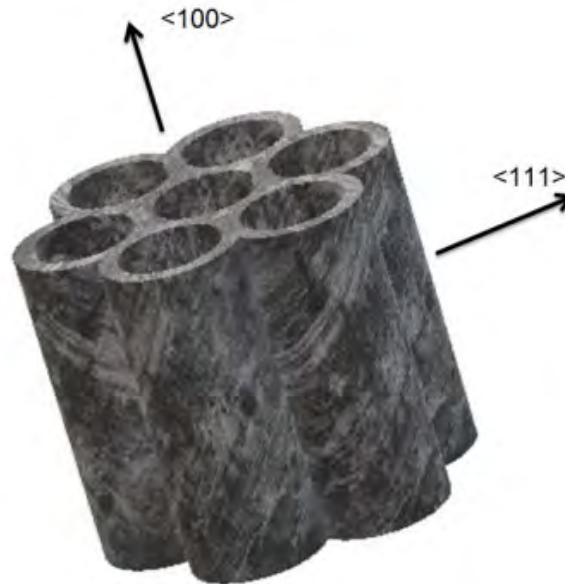
Figura 1. Esquema da subestrutura de células tubulares com paredes formadas por emaranhados compactos de discordâncias
