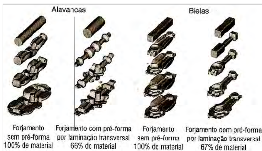
Figura 2. Economia de material que pode ser obtida com o uso de pré-formas. (6)
