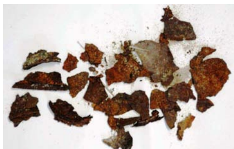
Figura 16 – Latas de leite em pó após exposição na superfície do ambiente marinho por 6 anos (após 7 anos não foi possível identificar fragmentos dessas latas no campo de teste).
