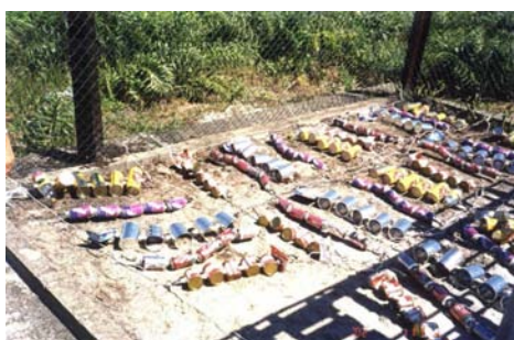
Figura 4 – Sistema de módulos para exposição das embalagens no ambiente marinho.
