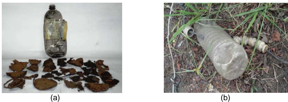
Figura 12 – Embalagens de óleo de soja dispostas na superfície do ambiente industrial: a) fragmentos das latas e garrafa PET após 6 anos; b) local onde estavam dispostas as latas e a garrafa PET após 7 anos (nesse período não foi possível identificar fragmentos das latas no campo de teste).
