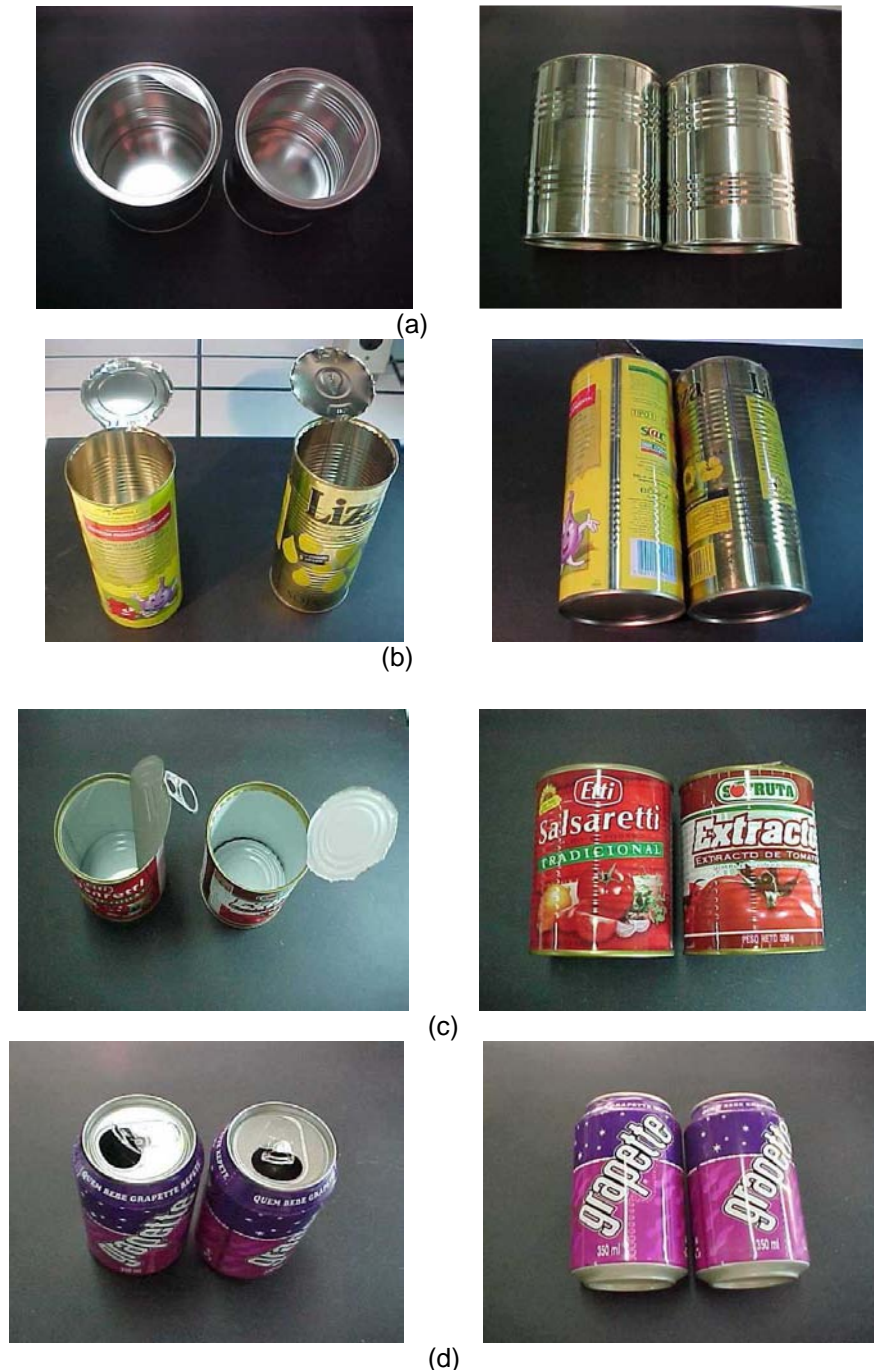
Figura 1 – Embalagens de aço utilizadas no trabalho antes de serem expostas nos campos de teste (amostras de referência): a) latas de leite em pó; b) latas de óleo de soja; c) latas de derivados de tomate; d) latas de aço DWI de refrigerantes.
