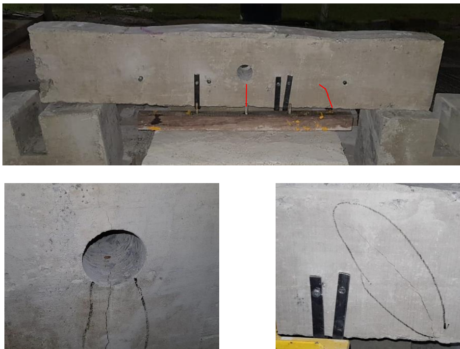
Figura 8. Fissuras apresentadas na viga reforçada com uma barra de aço, após um carregamento de 8.000 kgf.
