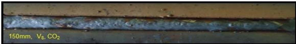
Figura 5. Aspecto superficial do cordão de solda. Processo GMAW, com velocidade de alimentação de arame de 8 m/min ou V_8 , CO_2 .
