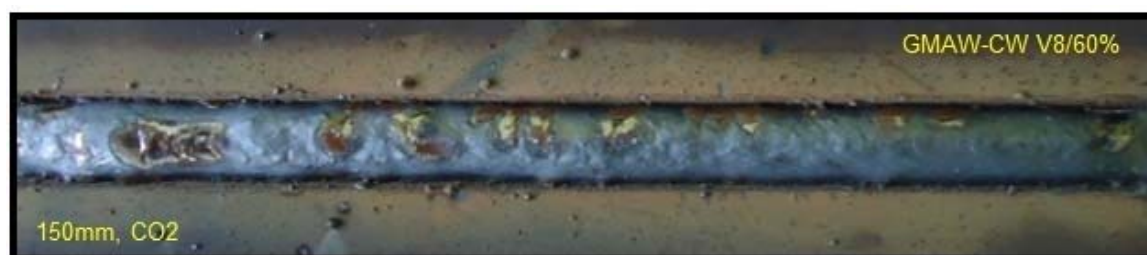
Figura 10. Aspecto superficial do cordão de solda. Processo GMAW-CW com adição de arame frio, com velocidade de alimentação de arames eletrodo/ frio igual a v8/60% m/min.
