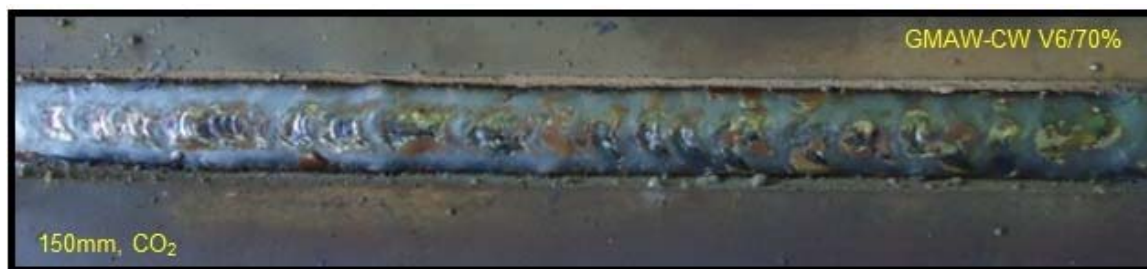
Figura 8. Aspecto superficial do cordão de solda. Processo GMAW-CW com adição de arame frio, com velocidade de alimentação de arames eletrodo/ frio igual a v6/70% m/min.
