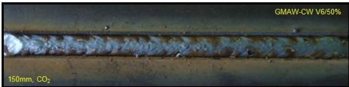
Figura 6. Aspecto superficial do cordão de solda. Processo GMAW-CW com adição de arame frio, com velocidade de alimentação de arames eletrodo/ frio igual a v_6/50\% m/min.
