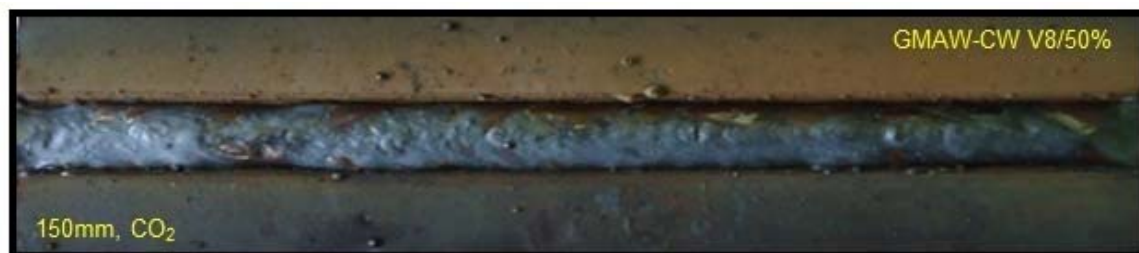
Figura 9. Aspecto superficial do cordão de solda. Processo GMAW-CW com adição de arame frio, com velocidade de alimentação de arames eletrodo/ frio igual a v8/50% m/min.
