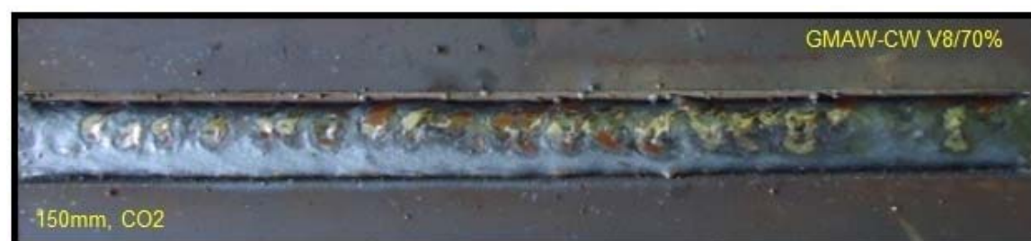
Figura 11. Aspecto superficial do cordão de solda. Processo GMAW-CW com adição de arame frio, com velocidade de alimentação de arames eletrodo/ frio igual a v8/70% m/min.
