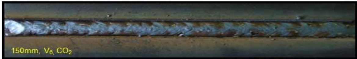
Figura 4. Aspecto superficial do cordão de solda. Processo GMAW, com velocidade de alimentação de arame de 6 m/min ou V_6 , CO_2 .
