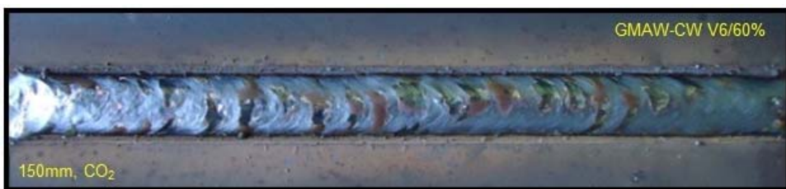
Figura 7. Aspecto superficial do cordão de solda. Processo GMAW-CW, com velocidade de alimentação de arames eletrodo/ frio igual a v_6/60\% m/min.
