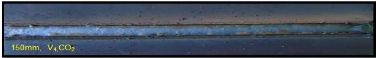
Figura 3. Aspecto superficial do cordão de solda. Processo GMAW, com velocidade de alimentação de arame de 4 m/min ou V_4 , CO_2 .
