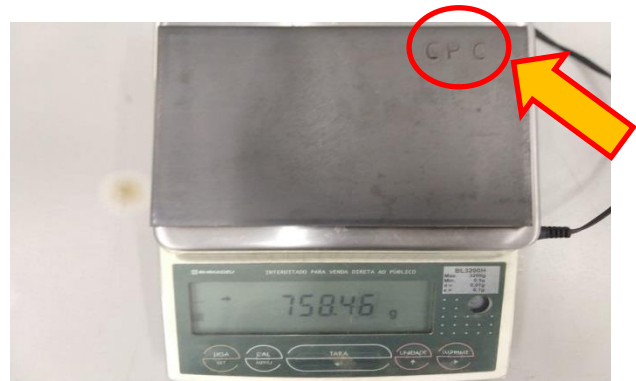
Figura 5. Dimensionando e aferindo a massa dos os corpos de prova de aço estrutural empregados neste trabalho. Pode-se notar a identificação puncionada na superfície dos CPs (conforme indicada).
