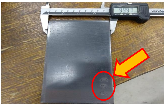
Figura 5. Dimensionando e aferindo a massa dos os corpos de prova de aço estrutural empregados neste trabalho. Pode-se notar a identificação puncionada na superfície dos CPs (conforme indicada).
