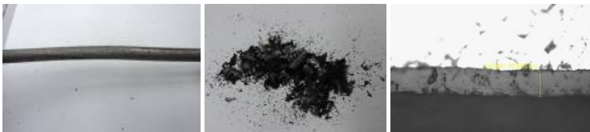
Figura 13. Aparência do fio máquina após ensaio de enrolamento e tração evidenciando a ausência de carepa aderente, ou subcarepa, a composição da carepa segundo microscopia óptica com ataque nital 3%, 1.000x e a quantidade de carepa desprendida após teste de enrolamento.
