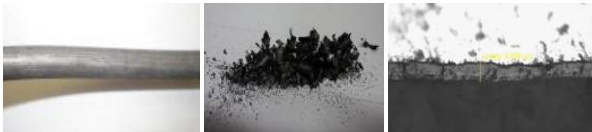
Figura 14. Aparência do fio máquina após ensaio de enrolamento e tração evidenciando a ausência de carepa aderente, ou subcarepa, a composição da carepa segundo microscopia óptica com ataque nital 3%, 1.000x e a quantidade de carepa desprendida após teste de enrolamento.
