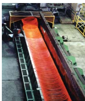
Figura 3. Vista de cima do Stelmor do laminador de Resende.
