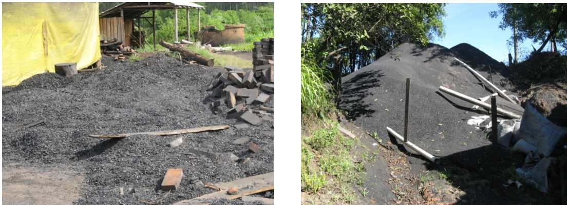
Figura 2. Descarte dos finos de carvão vegetal gerados nas carvoarias do interior do RS.
