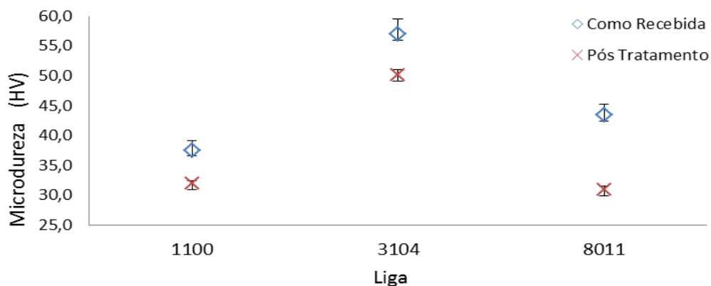
Figura 1: Microdureza a \frac{1}{4} espessura antes e após tratamento térmico.
