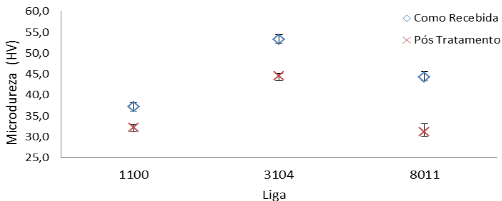
Figura 2: Microdureza a \frac{1}{2} espessura antes e após tratamento térmico.
