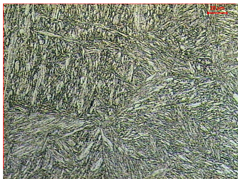
Figura 7: Microestrutura do aço do segmento do mandril, microscópio ótico. Reativo de Vilella, 500X.
