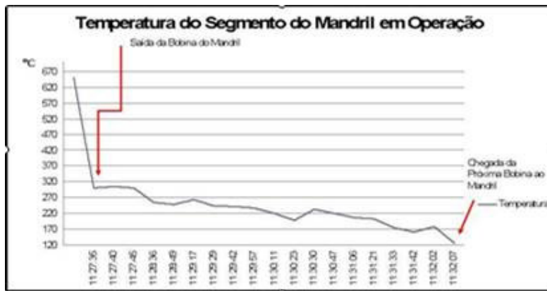
Figura 12: Medição da temperatura no centro do segmento do mandril entre o bobinamento de tiras (sem resfriamento à água). Aço SAE1008, temperatura de bobinamento = 600°C, dimensão 3,80 x 1.450 mm, peso 18,5t.
