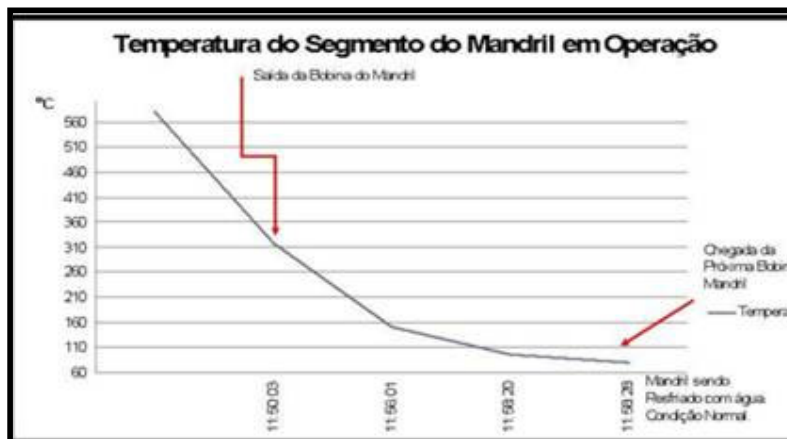
Figura 13: Medição da temperatura no centro do segmento do mandril entre o bobinamento de tiras (com resfriamento à água). Aço SAE10006, temperatura de bobinamento = 580°C, dimensão 3,30 x 1.340 mm, peso 19,0t.
