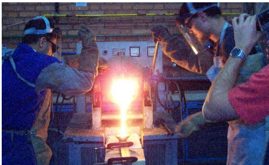
Figura 2. Processo de vazamento do material, diretamente do forno, sobre o Viscosímetro Herty.
