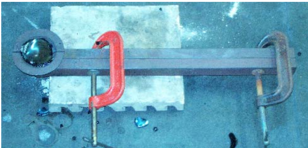
Figura 3. Viscosímetro Herty após o resfriamento do material vertido sobre ele.
