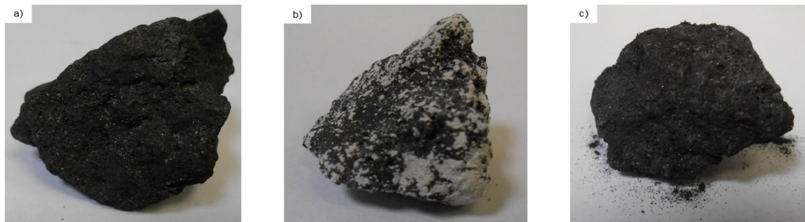
Figura 8. a) Small coque sem adições, b) small coque com 3% de cal virgem e c) small coque com 3% de pellet feed
