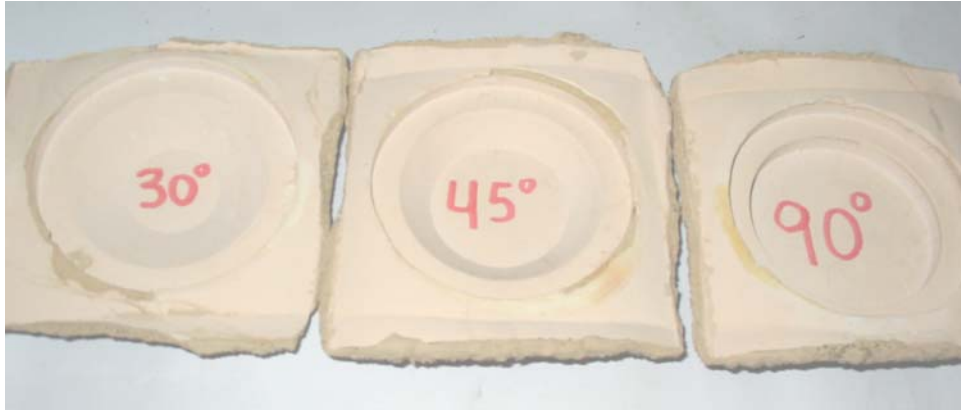
Figura 2: Moldes cerâmicos com paredes internas de diferentes ângulos.
