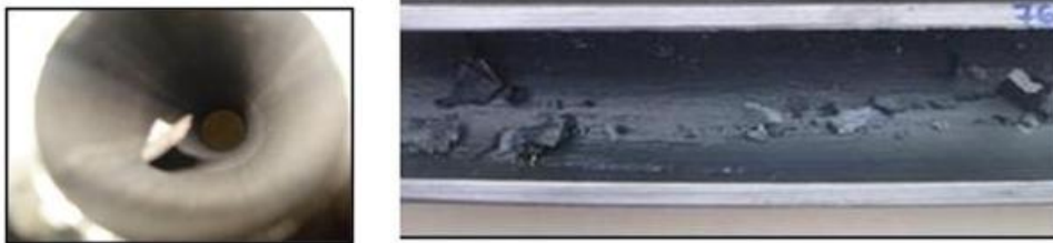
Figura 1. Exemplos do defeito dobra interna nos tubos da V&M do Brasil.
