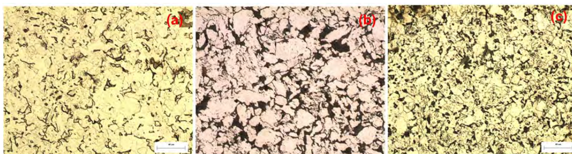
Figura 1. Micrografias (MO - 500x) dos sinterizado a 1150°C por 30 minutos; (a) Eurofer Puro, (b) Eurofer com TaC UFRN e (c) Eurofer com TaC comercial.
