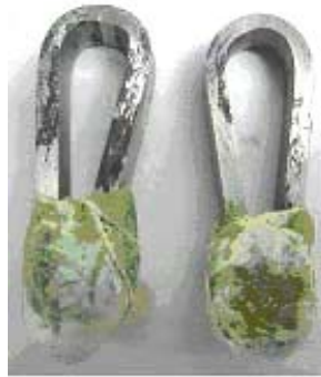
Figura 3 - Corpos-de-prova de aço inoxidável ferrítico (AISI 439) soldado com metal de enchimento de aço inoxidável austenítico (AISI 308); em soluções aquosas contendo 42% MgCl_2 ( 143^\circ C ).
