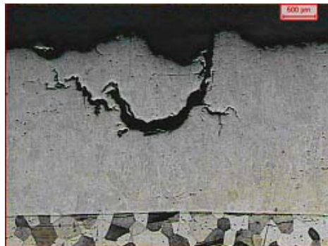
Figura 6 - Fotomicrografia de um CP trincado por CST. Nota-se que a trinca principal está na região do aço inoxidável austenítico (cordão de solda); 50X. Reativo: Vilela.
