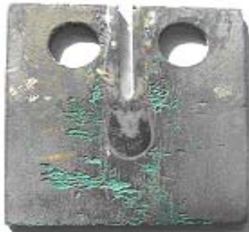
Figura 10 - Corpo-de-prova ensaiado sob tensão; neste caso o CP não sofreu CST, mas sim ataques na região ferrítica (MB e ZTA), principalmente, na zona de ligamento do CP; soluções aquosas contendo 42% MgCl_2 ( 143^\circ C ).
