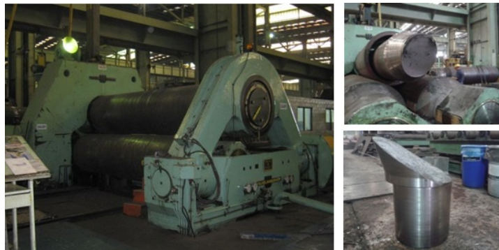
Figura 1 - Dano causado em máquina operatriz durante processamento a frio de um aço ARBL.
