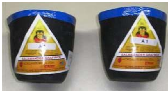
Figura 2. Cadinhos de Grafite - Argila usados na fusão das escórias.
