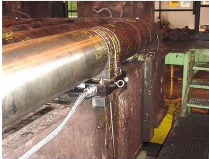
Figura 6. Posicionamento da Célula de Carga
