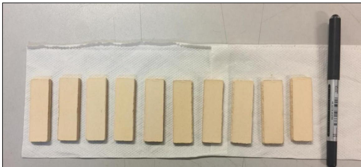
Figura 6 - Corpos de prova sinterizados a 1000°C. Fonte: Autores (2019).
