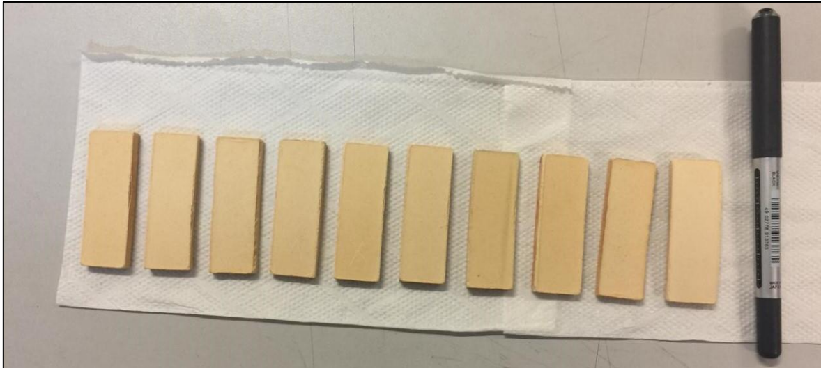
Figura 7 - Corpos de prova sinterizados a 1100°C. Fonte: Autores (2019).
