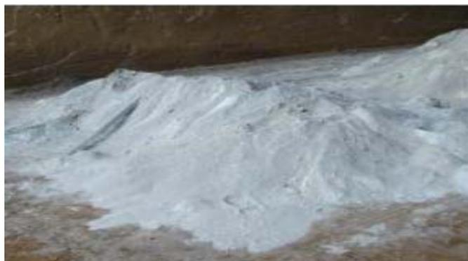
Figura 1. Escória de forno panela (EFP). Fonte: Masuero.
