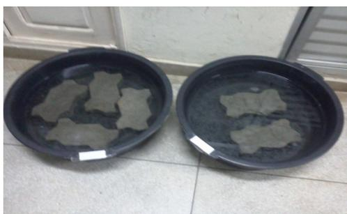
Figura 5. Blocos Intertravados imersos em água.
