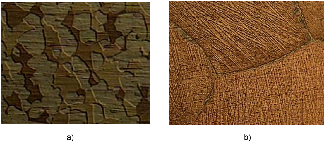
Figura 3. Micrografias do fio de Cu-Zn-Al: a) sem tratamento e b) tratada. Aumento 400X
