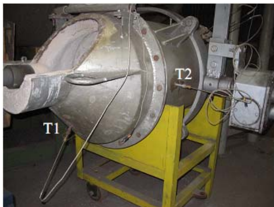
Figura 12. Distribuição dos termopares (T1, T2, T3, T4, T5 e T6) no corpo da nova panela de nodularização. (3)
