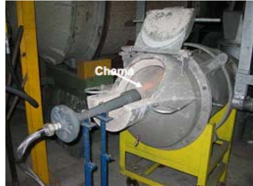
Figura 11. Posicionamento do queimador na nova panela de nodularização. (3)
