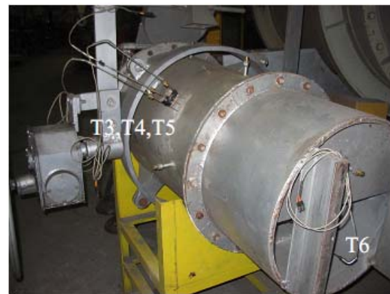
Figura 12. Distribuição dos termopares (T1, T2, T3, T4, T5 e T6) no corpo da nova panela de nodularização. (3)
