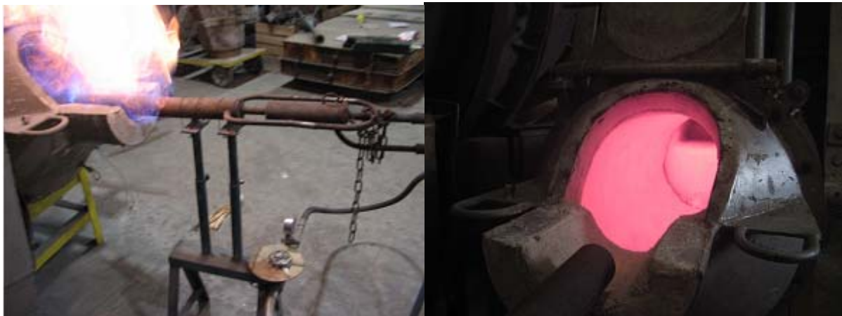
Figura 16. Panela de nodularização aquecida com queimador a ar comprimido. (3)
