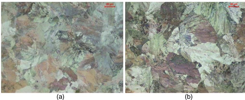
**Figura 4** - Micrografias dos aços (a) *S* e (b) *P1*, 500X, ataque Nital 2%.
