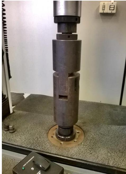
Figura 4: Dispositivo de cisalhamento usado para os ensaios dos pinos.
