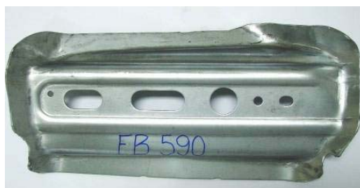
Figura 9: Estampagem do componente com o material FB 590.
