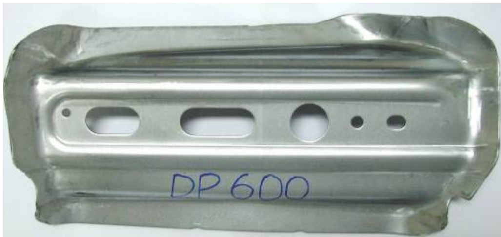
Figura 2: Reforço do cruscotto estampado com o material normal produção: DP 600.
