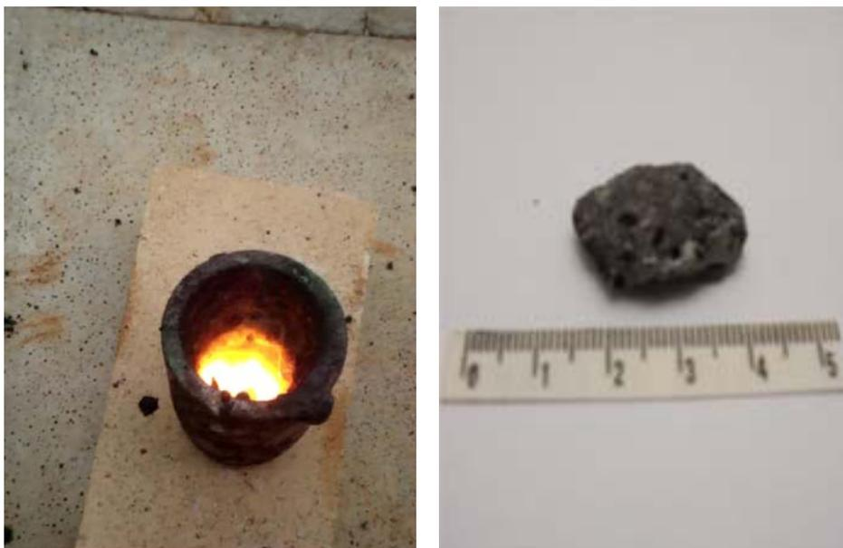
**Figura 5.** Imagem do cadinho (a) logo após o término da reação aluminotérmica do resíduo galvânico e (b) produto da reação retirado do cadinho após o resfriamento.
