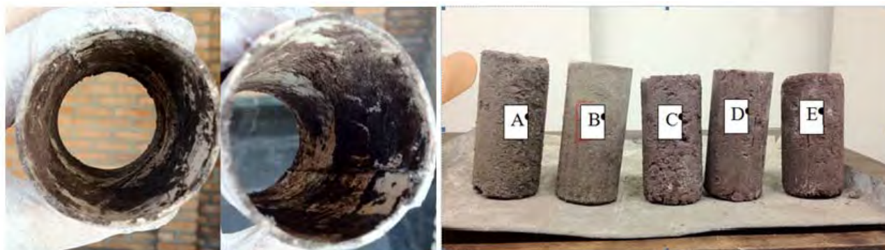
Figura 10. Paredes internas dos moldes de PVC para blocos de concreto, mostrando material aderido após desmoldagem de misturas contendo rejeitos finos da concentração de minério de ferro. Fotografia mostrando os blocos de concreto produzidos nas formulações de A a E, destacando o acabamento superficial após desmoldagem.
