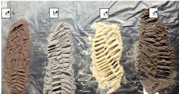
Figura 6. Fotografia mostrando secagem de areia comercial e de rejeitos de concentração de minério de ferro, sendo (a) rejeitos finos da concentração magnética, (b) rejeitos da flotação, (c) areia comercial e (d) rejeitos grossos da concentração magnética.
