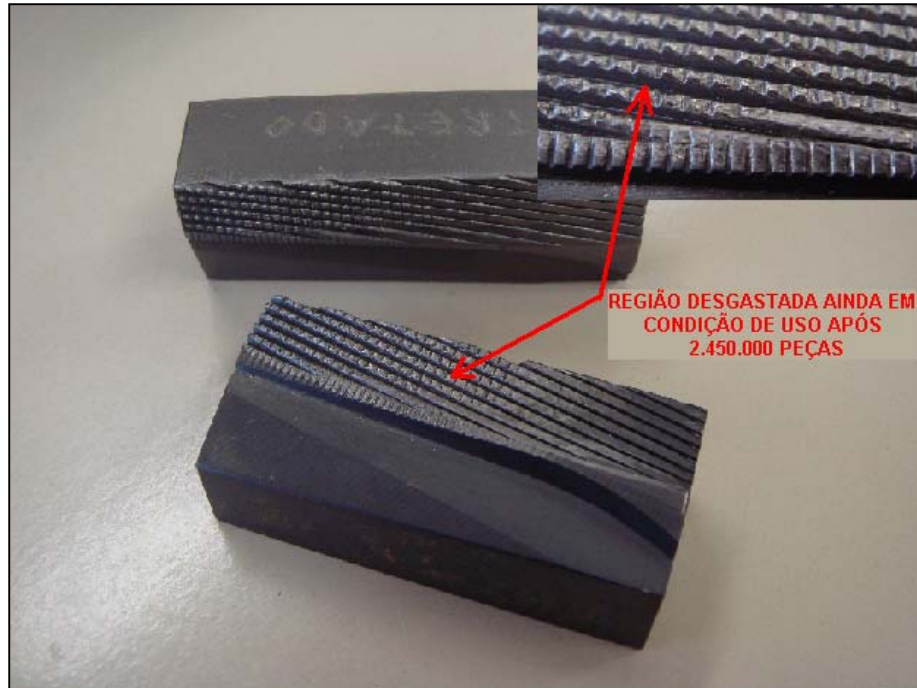
Figura 10: Pente de laminação modelo TR0 chip-board 3,5 desgastado.
