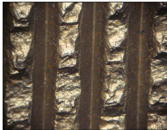
Figura 12: Forma de desgaste do pente não nitretado.
