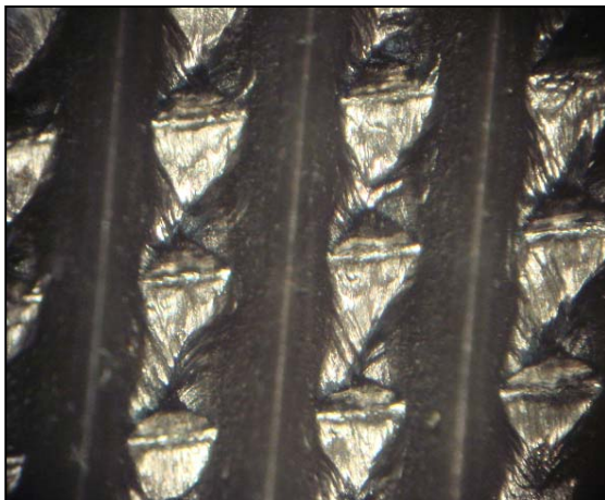
Figura 11: Forma de desgaste do pente nitretado.
