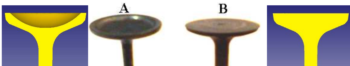
Figura 1: Geometria das válvulas produzidas por forjamento a quente A) Nova “Tipo Cálice” e B) Maciça Plana.
