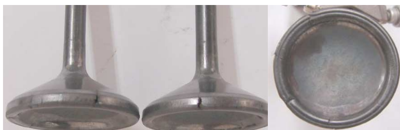
Figura 2: Defeitos apresentados nas válvulas consideradas RUINS.
