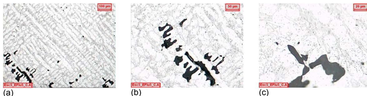
Figura 9 Amostra elaborada com uma mistura de 5g de fluxo exotérmico e 5g de escória com: (a) 100X de aumento; (b) 200X de aumento; (c) 500X de aumento. Ataque: Nital 2%. Região de
