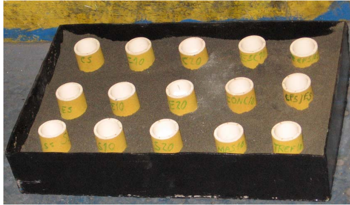
Figura 2 Suporte utilizado para fixação dos cadinhos para coleta das amostras.
