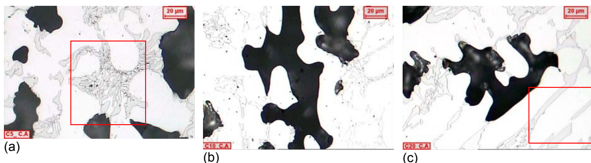
Figura 8 (a) Amostra elaborada com 5g de fluxo exotérmico – C5; (b) amostra elaborada com 10g de fluxo exotérmico – C10; (c) amostra elaborada com 20g de fluxo exotérmico – C20. Aumento: 500X. Ataque: Nital 2%. Região de coloração preta evidencia o fluxo; região de coloração acinzentada evidencia carbonetos.
