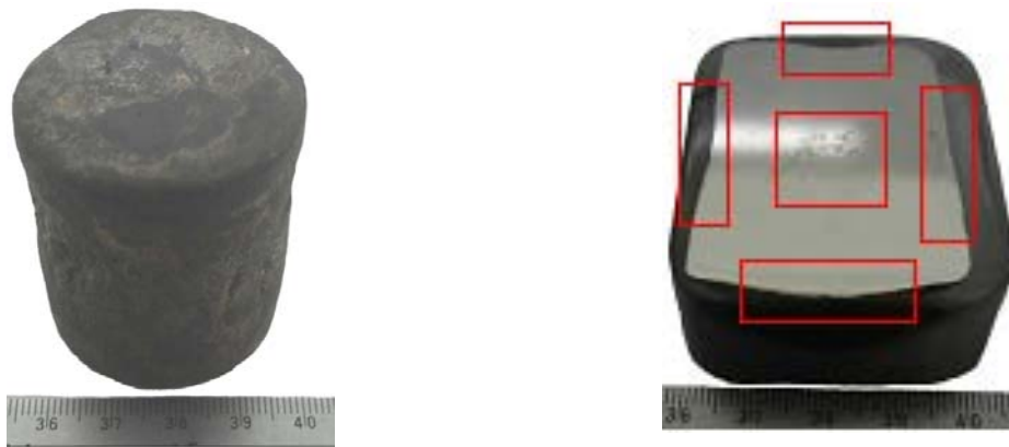
Figura 4 (a) Amostra típica no estado bruto de fusão após desmolde do cadinho. (b) Amostra seccionada transversalmente e preparada para caracterização microestrutural – os detalhes (retângulos na cor vermelha) mostram as regiões típicas de aprisionamento das inclusões e de onde foram feitas as análises metalográficas comparativas.
