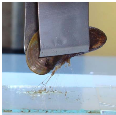
Figura 3- Filamentos do bisso de um exemplar de mexilhão dourado aderido a uma lâmina de vidro sendo estirados quando submetidos ao ensaio de tração.
