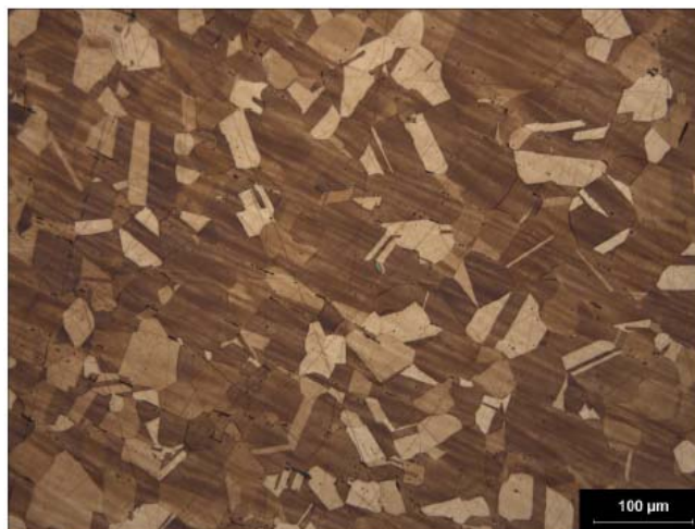
Figura 4 – Microestrutura do Aço AISI 316 inicial.
