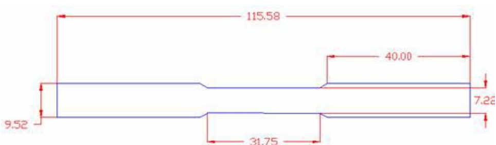
Figura 3. Detalhe do corpo de prova para ensaio de tração.
