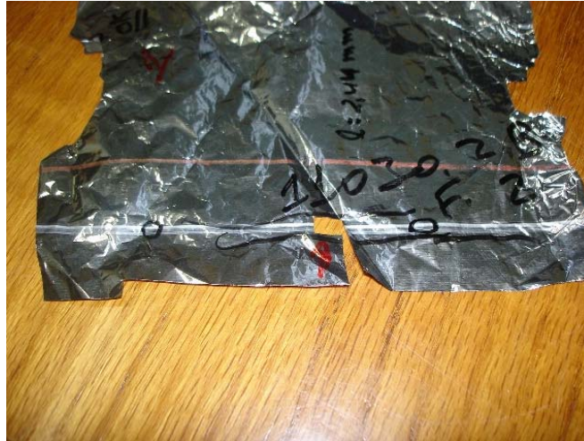
Figura 22. Folha de alumínio de espessura 6,3 \mu m, apresentando defeito superficial caracterizado por uma faixa branca que se estende ao longo do sentido de laminação e cuja largura é de 2,66mm, 13/04/2008.
