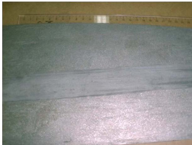
Figura 1. Defeito na chapa laminada a quente após decapagem.
