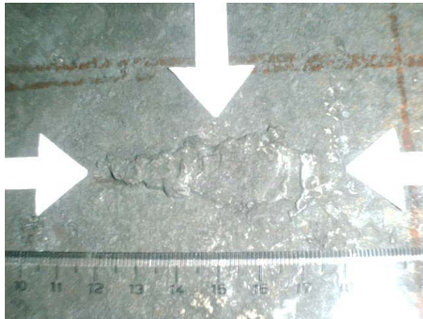
Figura 3. Defeito na placa após forno de reaquecimento da placa.
