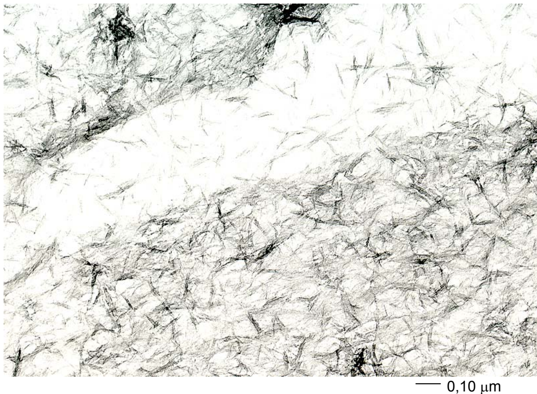
Figura 2. MET de uma rede de fibrilas obtida a partir de um sol envelhecido por 24h, material sintetizado via alumínio em pó em meio a ácido acético. (9)
