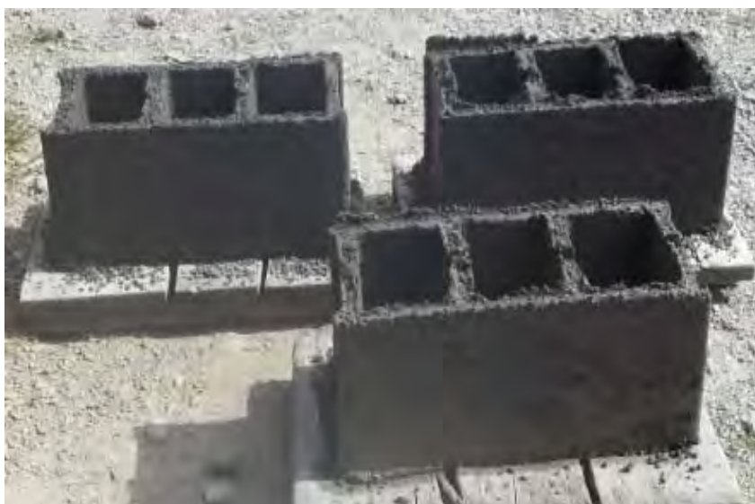
Figura 4. Blocos de concreto com carepa que serão avaliados no projeto.
