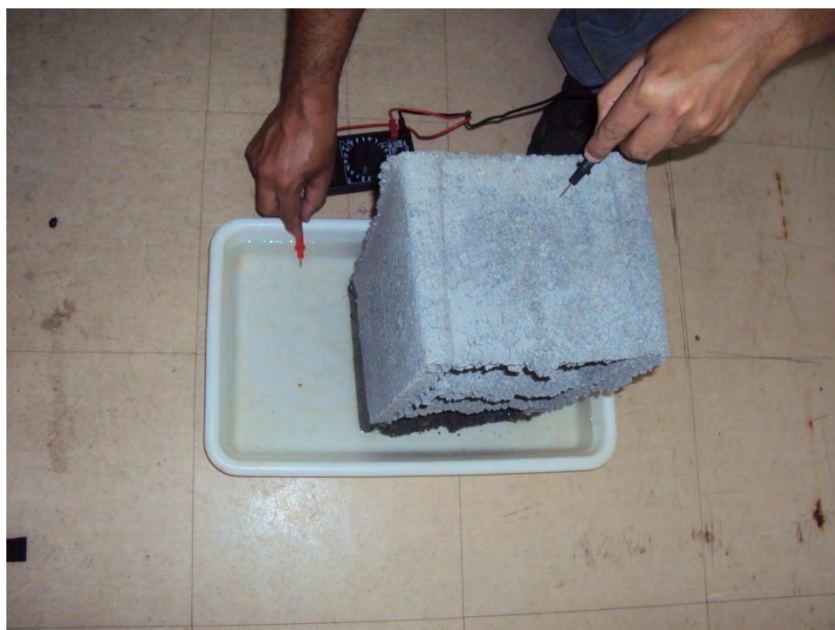
Figura 6. Medida da condutividade elétrica e da tensão em bloco de concreto com carepa imerso em solução salina (água deionizada) a 3% em massa.
