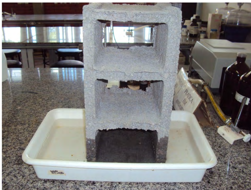
Figura 5. Bloco de concreto com carepa imerso em solução salina (água deionizada) a 3% em massa.
