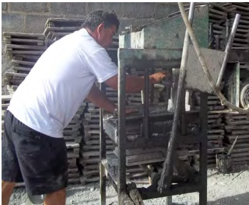
Figura 3. Fabricação do bloco de concreto com carepa com uso de máquina Vibro Prensa.
