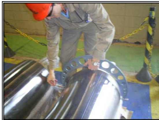
Figura 1 - Inspeção Dimensional no Rolo
