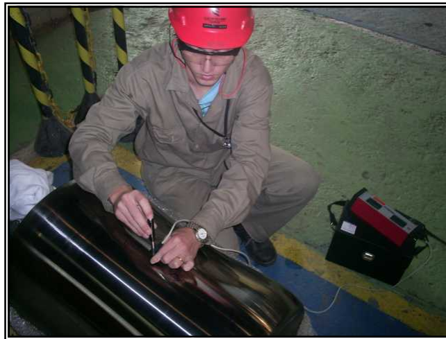
Figura 4 - Análise da Dureza do Rolo
