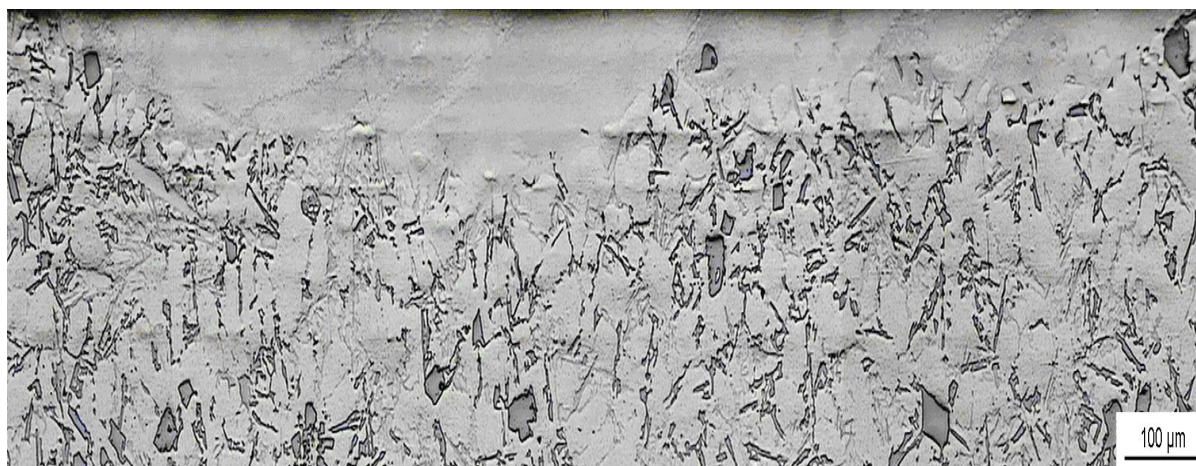
Figura 5. Micrografia óptica da seção transversal da liga Al-Si após irradiação com trilhas (condição TRL3).
